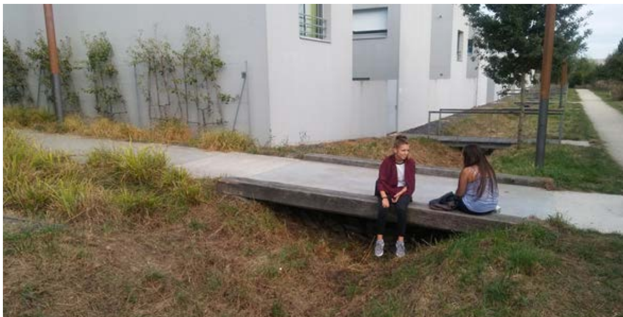
Obrázek 11: Využití vsakovacích průlehů v obytné zóně, příklad z eko-čtvrť Bottière-CHENAY v Nantes (Francie) (zdroj: Zuzana Hudeková)
