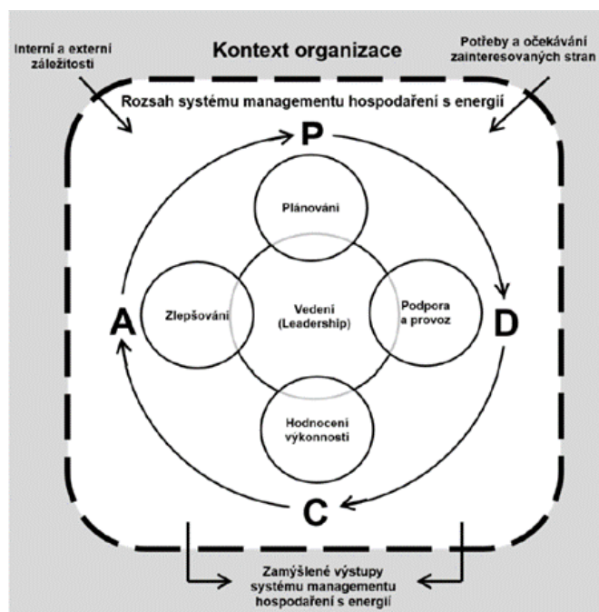
Obrázek 1 Schéma PDCA dle normy ČSN EN ISO 50001:2019
